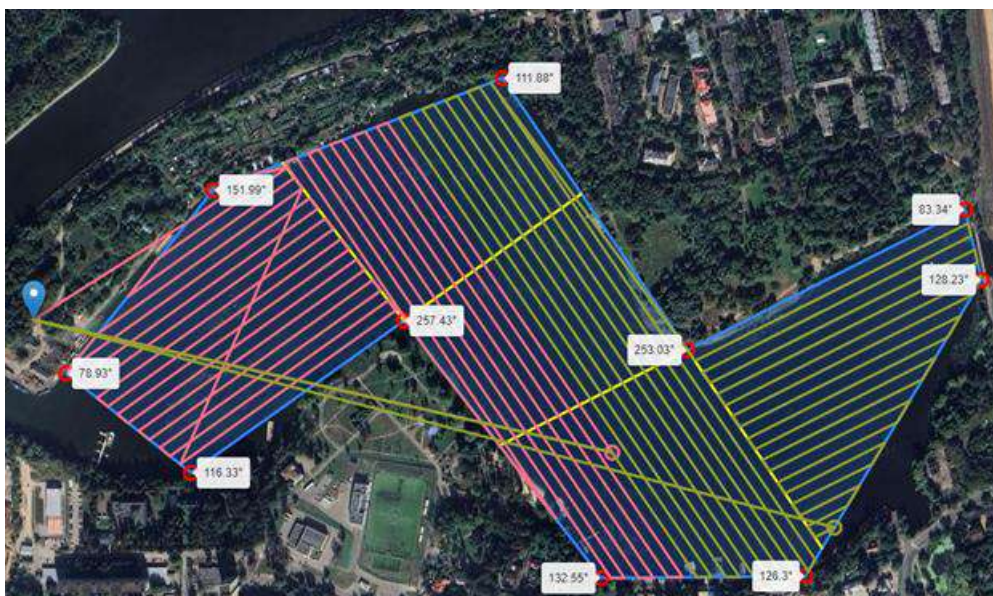
Рис. 3. Пример формирования маршрута для двух БПЛА
