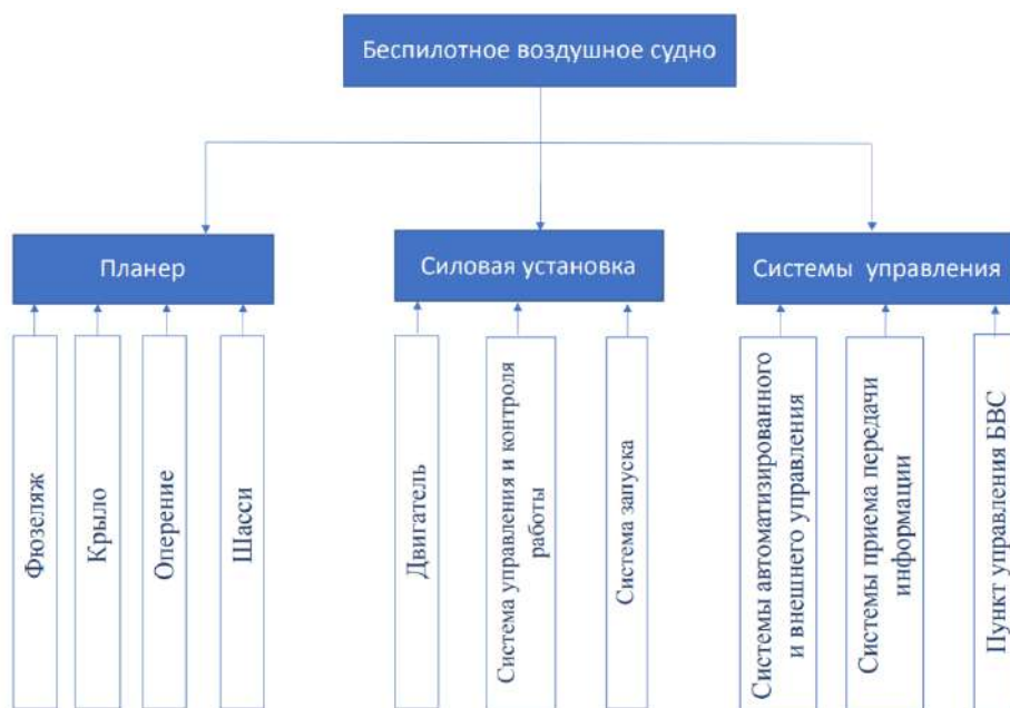
Рис. 2. Структура беспилотного воздушного судна
