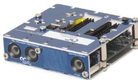
Рис. 5. Встраиваемый модуль стереозрения SVCam PRO
