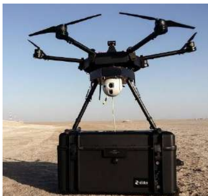
Рис. 4. Наземная станция питания привязных дронов LIGH-T
