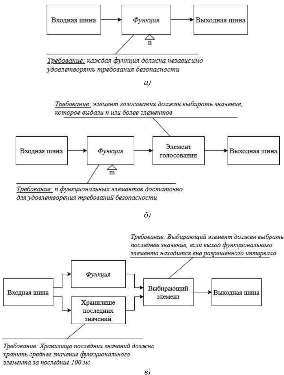
Рис. 2. (а, б, в). Архитектурные шаблоны: а) – резервирование, б) – голосование n-из-m, в) – восстановление прежнего значения
