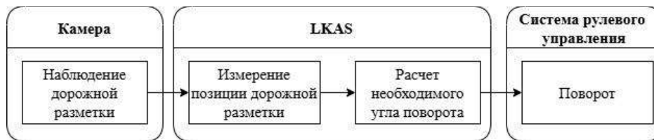
Рис. 4. Архитектура LKAS (предварительный вариант)
