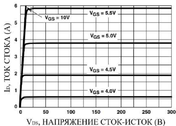
Рис. 3. График выходных характеристик транзистора IRF830APBF
