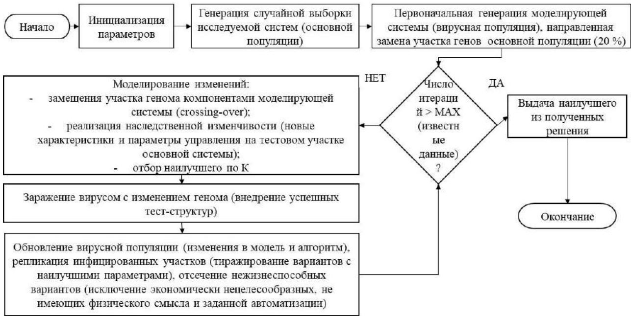
Рис. 4. Информационно-логическая схема вирусного эволюционирующего ГА (ВЕГА)
